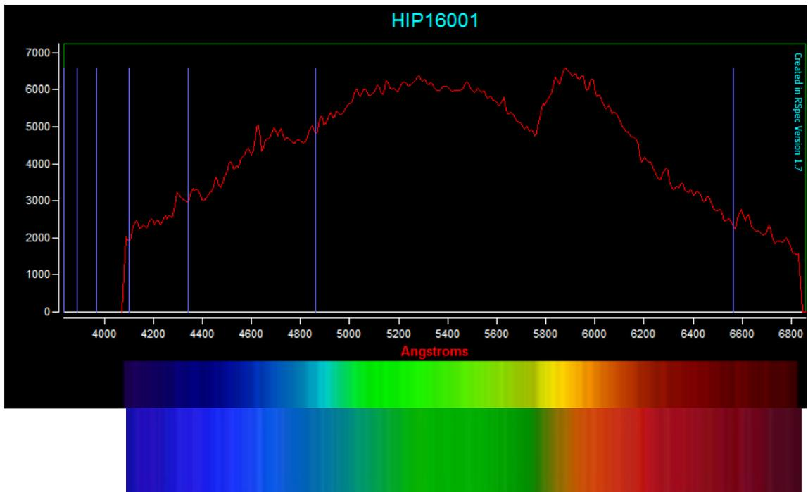
Podemos apreciar como ambos espectros han sido adecuadamente calibrados en las correspondencias de líneas y colores del espectro sintetizado por el Rspec y el espectro
